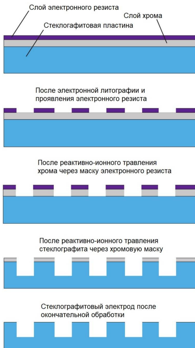
Рисунок 2.3 - Принципиальная схема процесса изготовления анодных электродов для ТЭП из стеклографитовой пластины.
