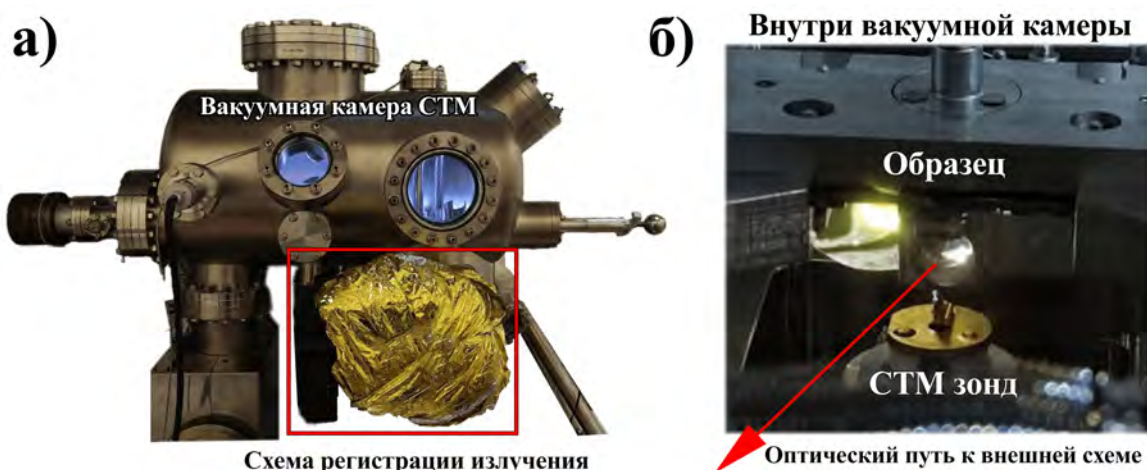
Рисунок 9 — Схема регистрации излучения из туннельного контакта: а) вакуумная камера СТМ и внешняя часть измерительной схемы; б) схема сбора оптического излучения внутри вакуумной камеры.
