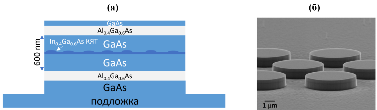
Рисунок 4.1 – (а) Схематичное представление слоев мезоструктуры с КЯТ InGaAs/GaAs; (б) изображение массива мезоструктур диаметром 4,5 мкм, полученных с помощью сканирующего электронного микроскопа.
