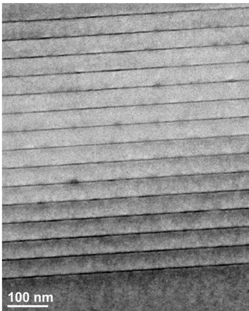
Рисунок 5. ПЭМ-изображение (100) структуры, содержащей 15 слоёв \text{In}_{0,4}\text{Ga}_{0,6}\text{As} КЯТ.
